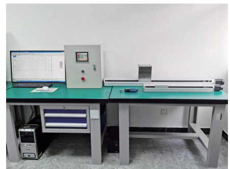
联轴器精度和寿命测试机
