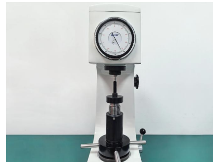
12.9级杯头螺丝硬度测试
