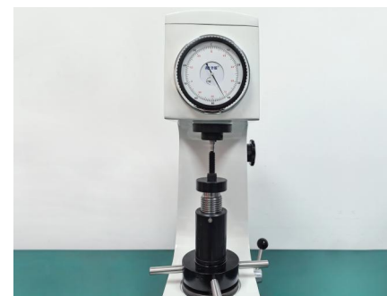
12.9级杯头螺丝硬度测试
