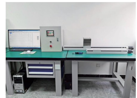
联轴器精度和寿命测试机
